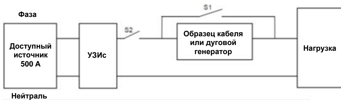
Рисунок 10 – Испытательная цепь для тестов маскирования (демпфирование и возмущающая нагрузка)
